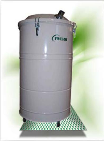
Die Industriesauger der Reihe 'S' sind entwickelt für die Absaugung von Papierschnipseln, Stoffresten und Stäuben von den Arbeitsleitungen bei der Textil-, Papier- und Verpackungsindustrie. Das abgesaugte Material fällt in einen Nylonsackfilter, der durch ein auf dem Behälter oben gelegtes Schaufenster Ø 100 übergeprüft werden kann.
