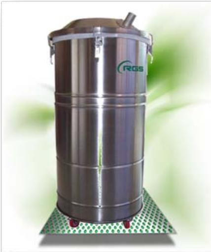
Die Industriesauger der Reihe 'S' sind entwickelt für die Absaugung von Papierschnipseln, Stoffresten und Stäuben von den Arbeitsleitungen bei der Textil-, Papier- und Verpackungsindustrie. Das abgesaugte Material fällt in einen Nylonsackfilter, der durch ein auf dem Behälter oben gelegtes Schaufenster Ø 100 übergeprüft werden kann.
