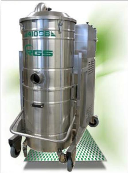
Diese Sicherheitssauger sind die ideale Lösung für die Arbeit in den Umgebungen, die in der ATEX Zone 22 Stäube (3D) klassifiziert sind, wo ein zuverlässiges, leistungsfähiges und praktisches Gerät gebraucht wird. Diese Modelle sind ausgerüstet mit :
